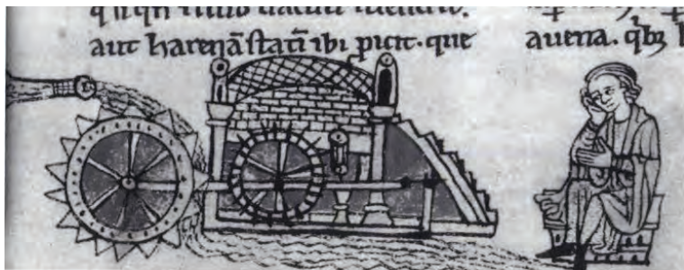
Ryc. 7. Średniowieczny młyn z kołem nasiębiernym, ilustracja z manuskryptu, ok. 1220–1230, BL Cleopatra cxi, fol. 10
