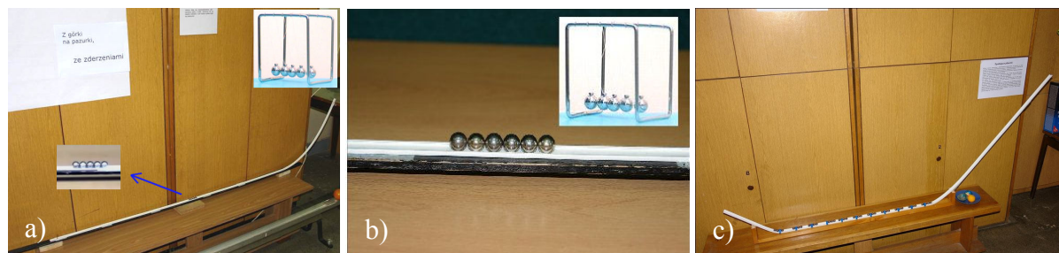
Fot. 4.9. „Z górki na pazurki, ze zderzeniami” – zjeżdżalnia Newtona: a) widok całości urządzenia – kulka zjeżdżająca z nachylonej części po prawej stronie uderza w pięć innych kulek spoczywających na równi; b) powiększenie miejsca zderzenia i jego pierwowzór – wahadło Newtona (w górnym rogu); c) kolejna modyfikacja idei wahadła Newtona – równia z magnesami w części poziomej, zwana też działem (tj. armatą) Gaussa; „naciąg” kulek w polu magnesów powoduje akumulację energii, która zostaje rekurencyjnie wyzwolona po uderzeniu przez kulkę nadlatującą z lewej strony; w konsekwencji ostatnia kulka z prawej strony wtacza się po równi wyżej niż wysokość, z której stoczyła się pierwsza kulka z lewej pochylni. (Festiwal Nauki Toruń, UMK, kwiecień 2007, idea i realizacja GK, współpraca W. Krychowiak, fot. KS)
