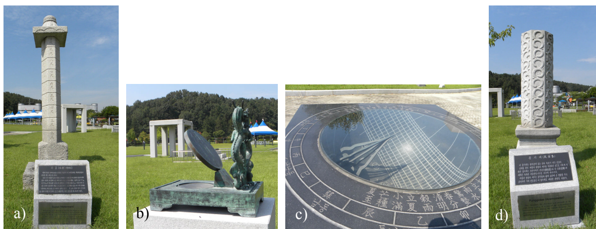
Fot. 5.38. Rekonstrukcje historycznych instrumentów meteorologicznych i zegarów słonecznych w Muzeum Nauki w Daejeon: a) wodowskaz na rzece Cheonggye; b) rekonstrukcja przenośnego zegara słonecznego z 1437 r. wykonanego z brązu (7-krotnie powiększona); c) zegar słoneczny Angubuilgu wynaleziony na początku XV wieku – niezwykle ciekawa, wklęsła konfiguracja powierzchni „cyferblatu”; d) anemometr – kierunek i siłę wiatru wskazywała chorągiewka na szczycie kolumny (fot. MK)
