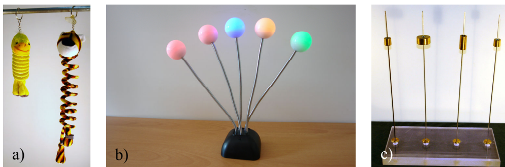
Fot. 4.12. Proste eksponaty do ilustracji ruchu drgającego: a) dwa bliźniacze eksponaty do zabawy „Dlaczego tygrys nie dogoni kurczaka?” – kurczak i tygrys z nogami na sprężynkach; tygrys dodatkowo obciążony „skarpetkami” z ołowiu; b) eksponaty do „ważenia” bez wagi, czyli do określania masy bez korzystania z prawa grawitacji – sprężyny zostały pieczołowicie wybrane spośród kilkunastu, tak aby miały ten sam okres drgań, dzięki temu mogą służyć do „ważenia”; c) ta sama idea co poprzednio, ale w eksponacie zaprojektowanym ab initio – walce o różnych rozmiarach mają okresy drgań mające się do siebie jak 1 : 2 (eksponaty i autor ścieżki GK, fot. KS)
