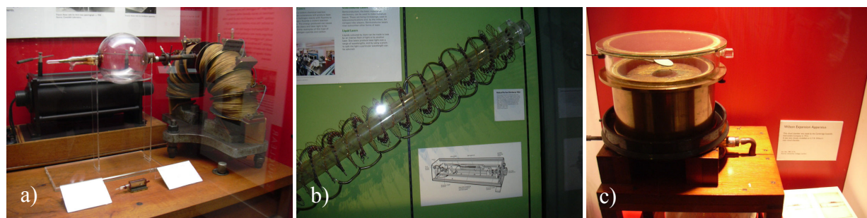
Fot. 6.17. Historyczne wynalazki – fizyka XX wieku. Science Museum, aranżacja z 2003 r.: a) pierwszy spektrometr masowy do rozdzielania mas jonów w stanie gazowym za pomocą pola magnetycznego (około 1915 r.); b) prototyp laser gazowego na CO 2 – ok. 1965 r.; c) Komora Wilsona do obserwacji cząstek promieniowania jądrowego (głównie cząstek alfa), ok. 1920 r. (fot. GK)
