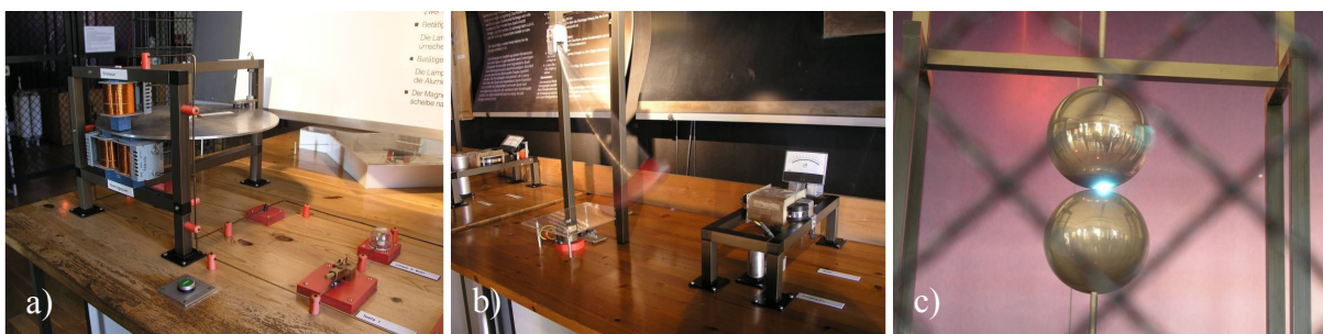
Fot. 6.42. Muzeum „Spectrum” w Berlinie: a) prądy wirowe, zastosowania praktyczne w liczniku prądu – zmienny prąd powoduje obracanie się tarczy; b) indukcja elektromagnetyczna – hamowanie aluminiowego wahadła w polu magnetycznym; c) wyładowania elektryczne między dwoma metalowymi kulami (fot. ŁK)
